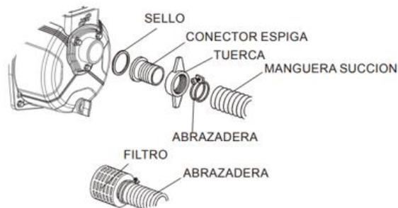
En el extremo de la manguera de succión se debe conectar el canastillo (colador) para evitar que ingresen partículas que dañe el interior de la bomba.
